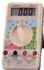
A l'aide d'un ampèremètre, monté **en série** avec le dipôle étudié (i.e.: placé dans la même branche). L'intensité lue est **POSITIVE** si le **courant conventionnel entre par la borne A et sort par la borne COM**.
