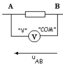
Pour mesurer la tension  $U_{AB}$ , on connecte le voltmètre comme schématisé ci-contre :
