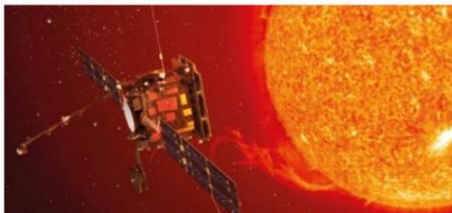
L'énergie électrique sera produite par des cellules solaires triple jonction. La dimension des panneaux solaires permet de fournir suffisamment d'énergie lorsque le satellite se trouve à sa plus grande distance du Soleil soit 210 millions de kilomètres. La demande de puissance maximale du satellite est de 1 000 W.
